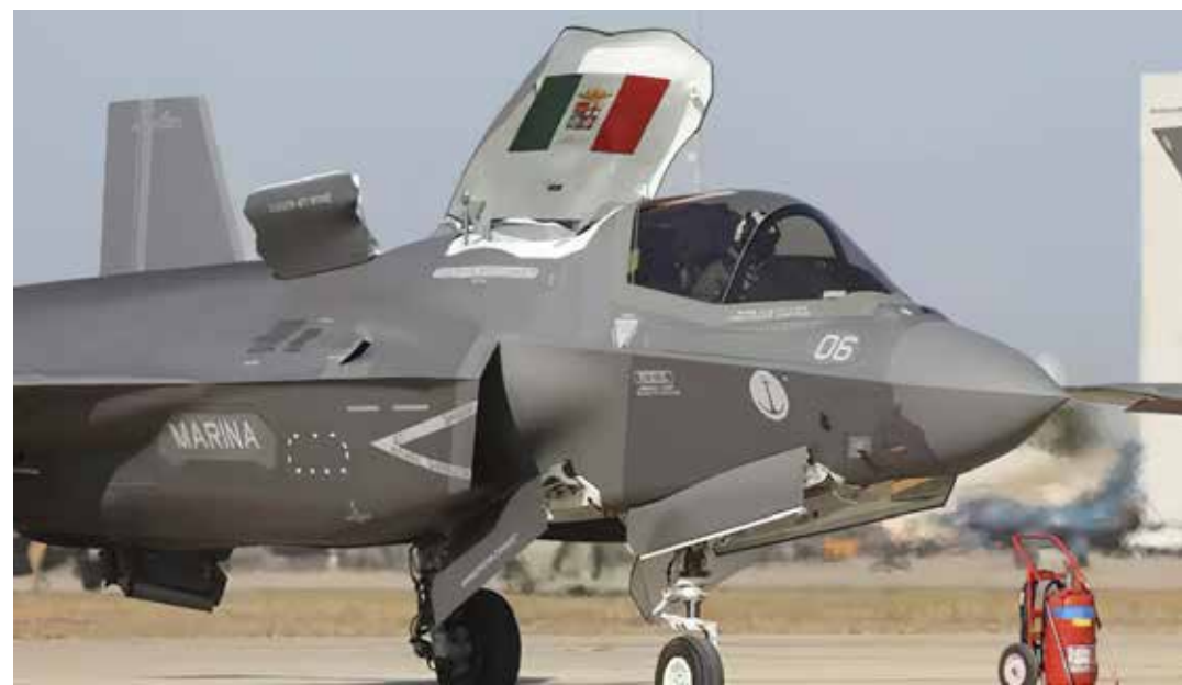
Un F35B, caccia a decollo corto e ad atterraggio verticale, come quelli imbarcati sulla Cavour
